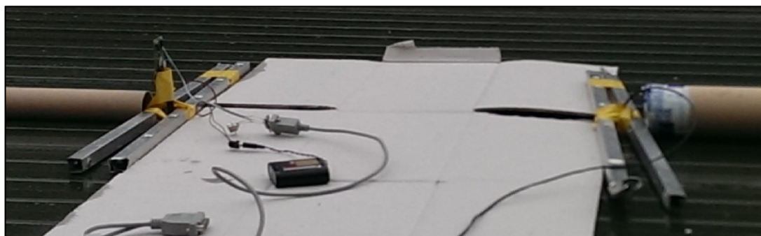
Figuur 28: Opstelling test IR led + fototransistor
